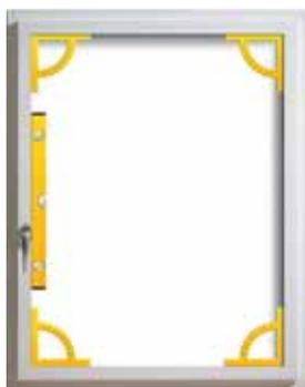
I profili del battente, saldati tra loro, sono perpendicolari.
